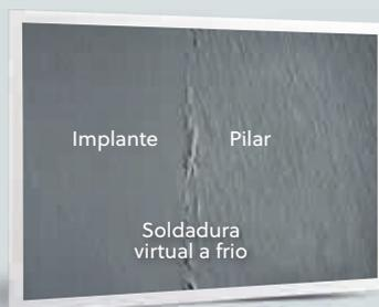
Maior ampliação da soldadura a frio virtual entre o pilar e o implante
